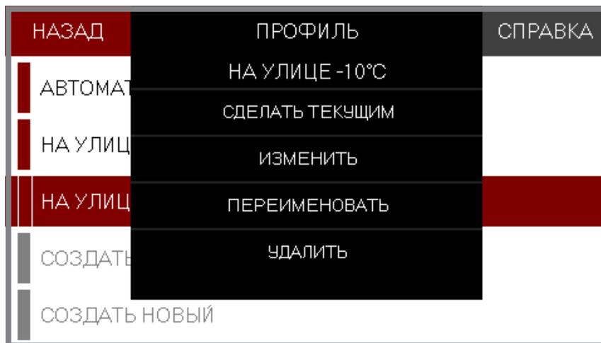
При изменении параметров профиля горелка переходит в режим ручной настройки. Данный режим позволяет выставить все параметры работы горелки в ручную. Он рекомендуется для пользователей, подробно изучивших руководство по эксплуатации на горелку и освоивших основные принципы работы горелки.
