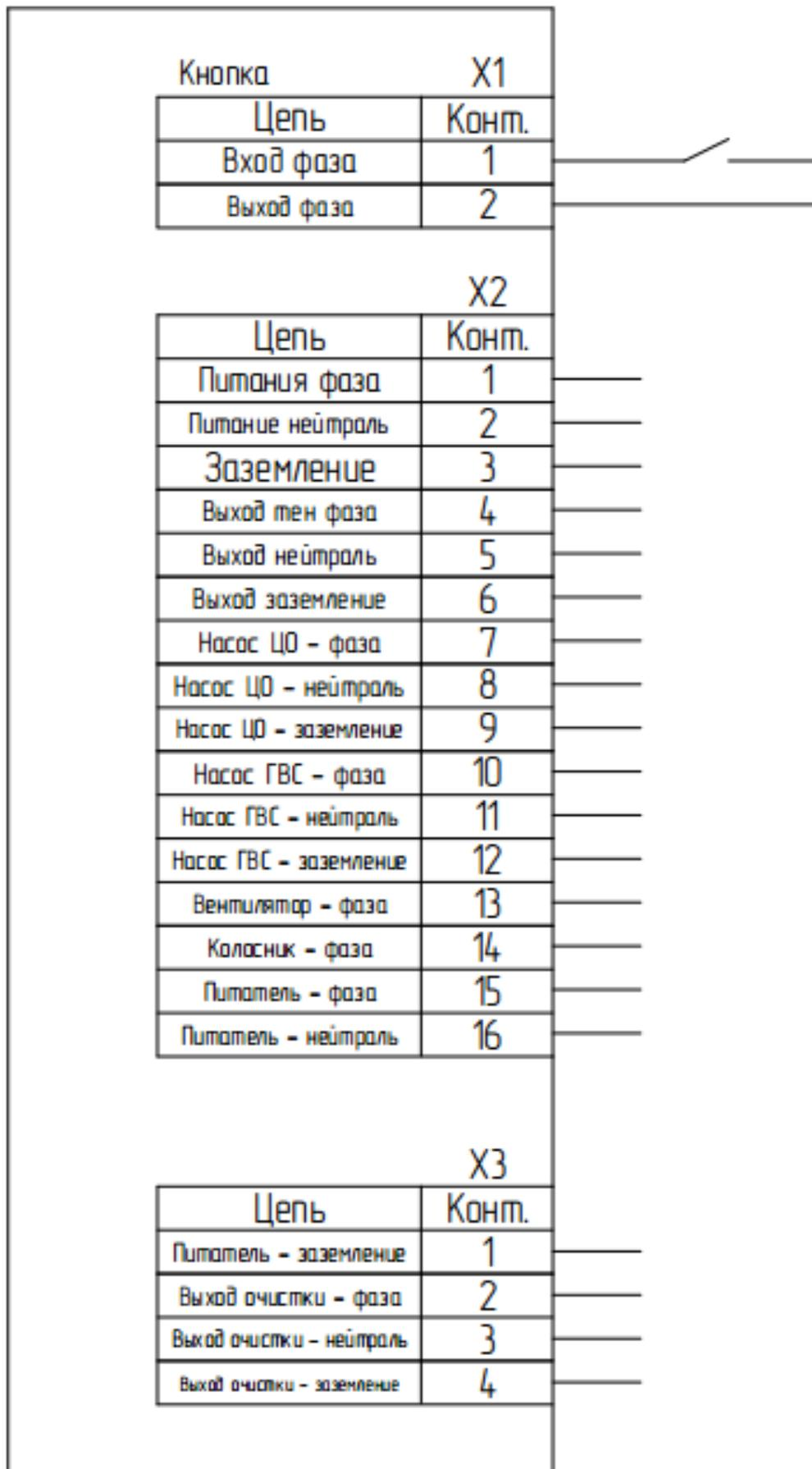
Рис. 8 – Подключение цепей на силовой плате БУ
