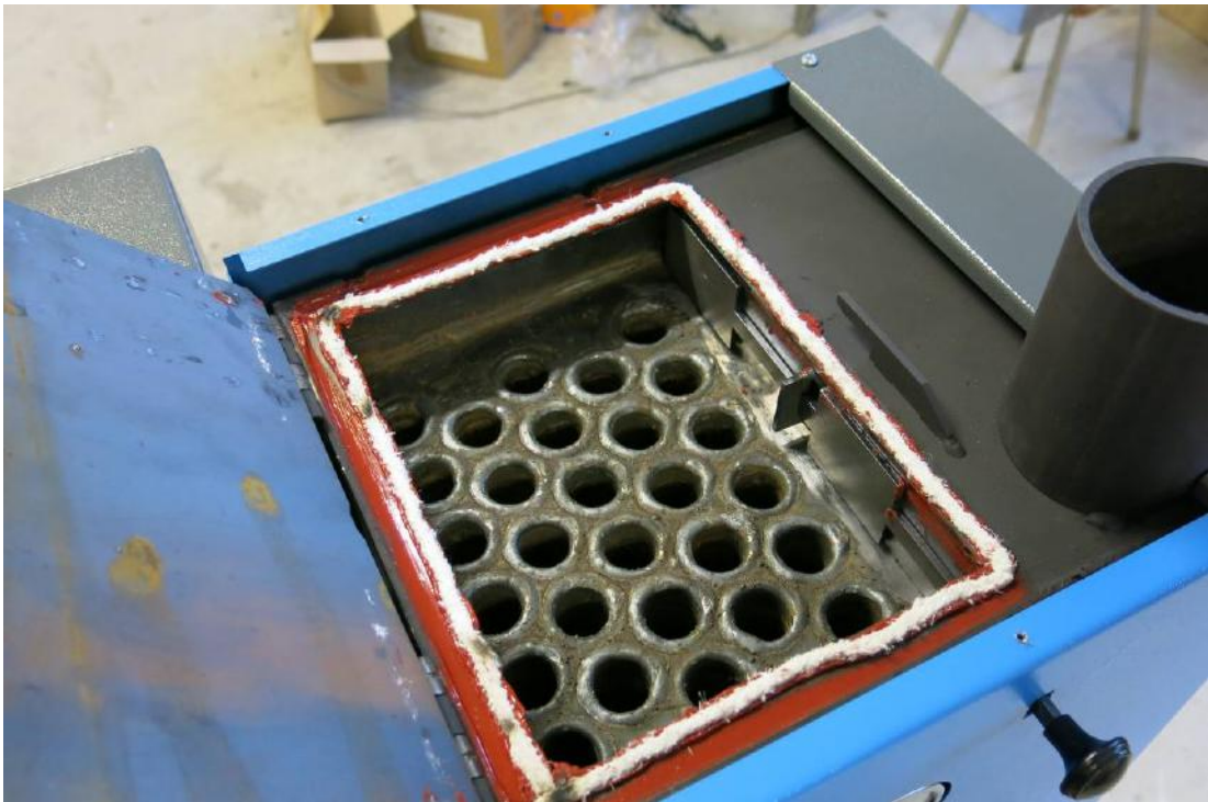
Рис. 8 - Доступ к прочистной крышке теплообменника
