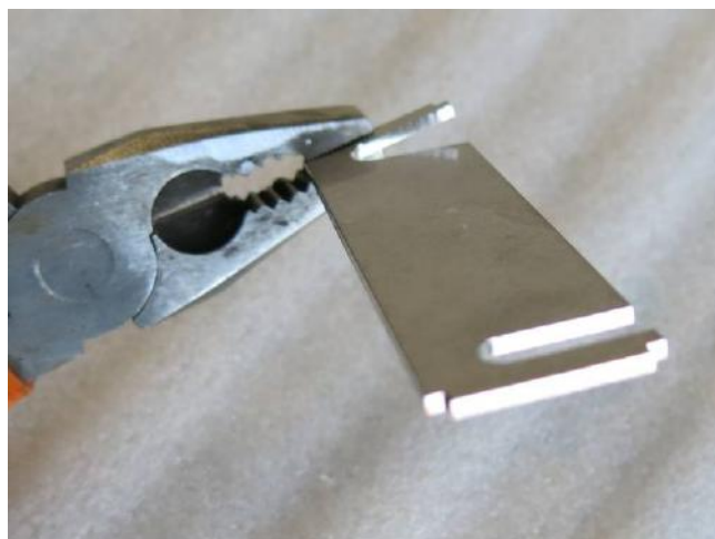
Рис. 34 - Отгибание краев полки
