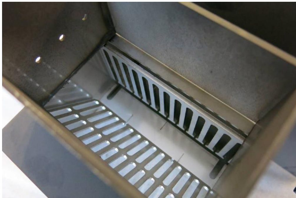
Рис. 21 - Продолжение установка корзины в горелку
