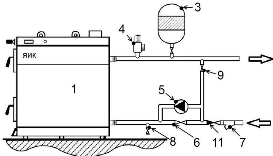
1. Котёл ЯИК 2. Расширительный бак открытого типа 3. Мембранный расширительный бак закрытого типа 4. Предохранительный клапан для аварийного сброса теплоносителя 5. Циркуляционный насос 6. Байпасный кран 7. Фильтр-ревизия 8. Кран заполнения или опорожнения системы отопления 9. Перепускной кран 10. Перелив 11. Обратный клапан
