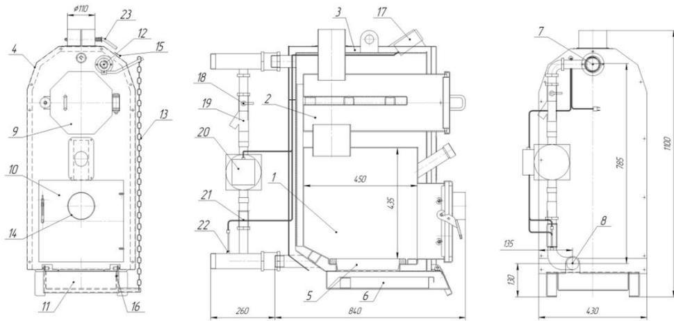
Рис. 1а. Габаритные размеры и элементы котла ТГЖ-10
